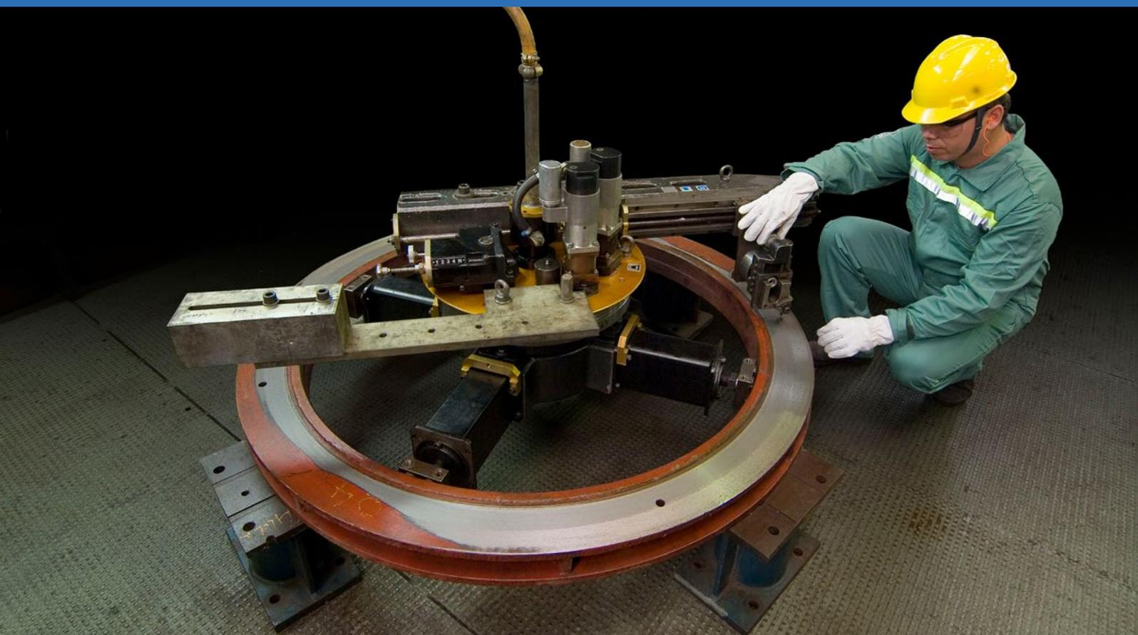
A Metalock Brasil utiliza equipamentos portáteis de usinagem, desenvolvidos de acordo com a necessidade dos serviços, transportados até o local indicado pelo cliente.
