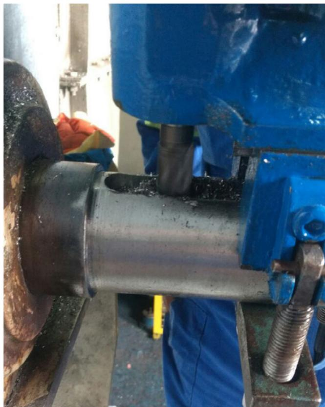
A tradicional fábrica da Mercedes-Benz do Brasil em São Bernardo do Campo (SP), identificou folga na Ponta de Eixo do ventilador de exaustão do refeitório principal. Devido às dimensões de grande porte do equipamento e difícil acesso para desmontagem, a Metalock Brasil foi acionada, em caráter emergencial, para realizar inspeção técnica e oferecer ao cliente possíveis soluções de reparo em campo.
