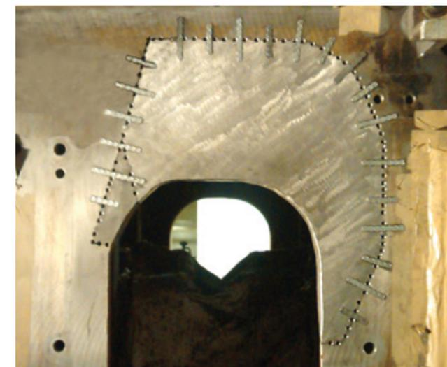
Metalock Brasil foi contratada para realizar o reparo do Motor Auxiliar MAN 8L27/38 n°1, que sofreu avarias na região do cilindro n° 7, decorrentes da quebra do contrapeso do eixo.
