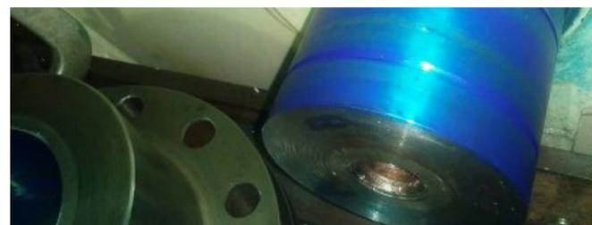
Os técnicos da Metallock Brasil realizaram um levantamento dimensional das profundidades dos sulcos, dano causado pelo desacoplamento do flange, e decidiram usinar o eixo cônico para diâmetro final, seguindo a norma de não alterar a sua geratriz.
