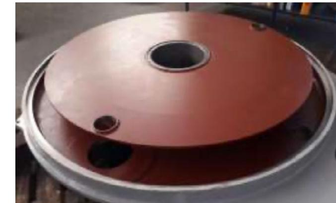
Empresa especializada no desenvolvimento de tecnologia avançada chama a Metalock Brasil, para reparo em placa de caixa de engrenagem e usinagem da superfície de travamento do eixo da roldana.
