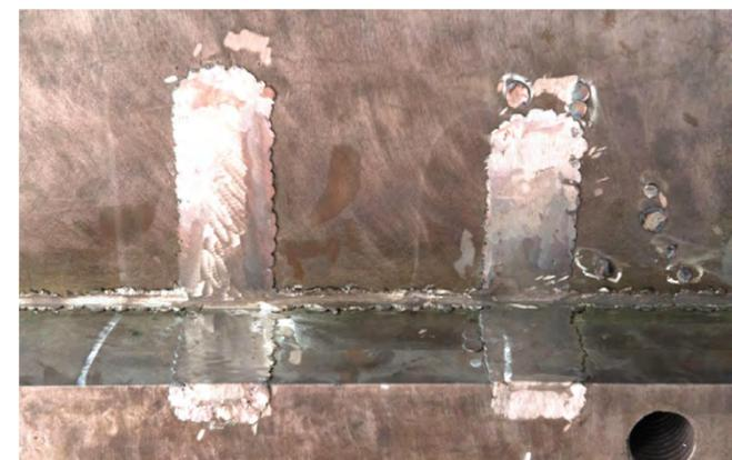
Fabricante de peças em ferro fundido, que atende setores de indústrias automobilísticas, siderúrgicas, papeleiras, de alumínio, ferroviárias, entre outras, contatou a Metalock Brasil para executar os reparos numa base fabricada por eles para um Centro de Usinagem de 4 Eixos. A base é o coração do Centro de Usinagem, seu desenho rígido permite alta performance e precisão de corte.
