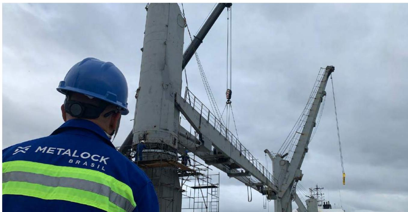
A Metalock Brasil foi acionada por armador Norueguês, com a finalidade de estudar em conjunto uma solução técnica de engenharia, para substituir o rolamento de giro de guindaste de carga SWL (*Safe Working Load*) de 36 toneladas, em seu navio de carga.
