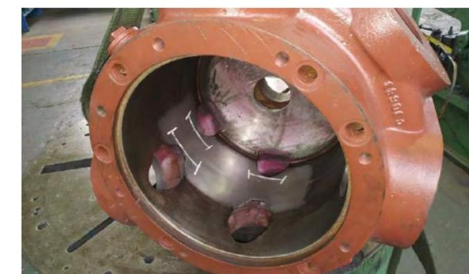
Empresa especializada em manutenção de compressores, para sopro de garrafa Pet, contatou a Metalock Brasil para reparar cilindro de compressor danificado.
