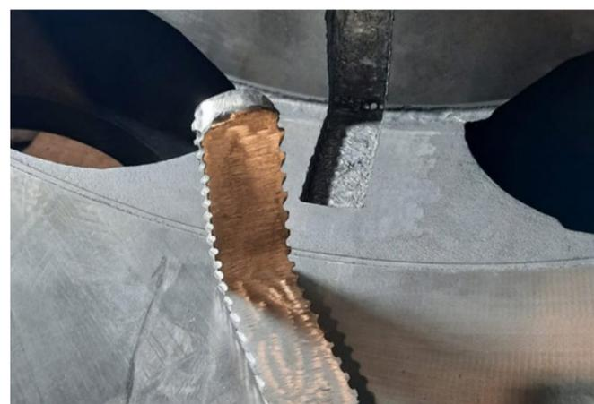
Metalock Brasil reparou um cilindro de compressor de uma das empresas líderes em fornecimento global de compressores, sopradores e bombas de vácuo.
