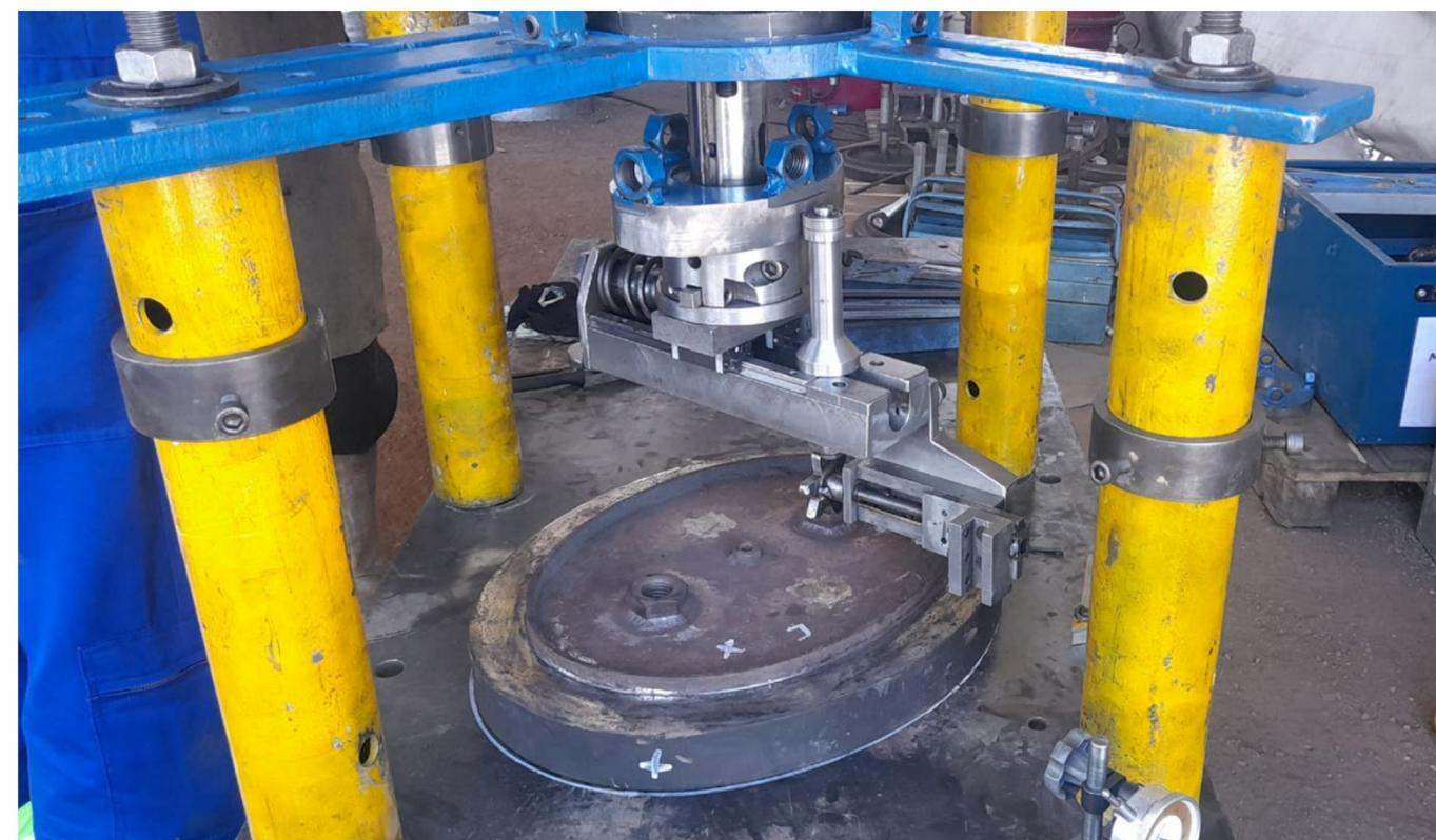
A Metalock Brasil foi procurada por uma siderúrgica para desenvolver uma solução inovadora para um trabalho de usinagem: usinar a face interna de uma porta de visita da caldeira inferior de alta pressão com 320mm de largura e 420mm de comprimento, que apresentava uma irregularidade de 4,5mm no paralelismo, copiando o seu formato elíptico e tampas com ranhuras concêntricas.
