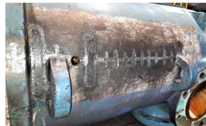
Metalock Brasil foi contratada para restaurar um cilindro de compressor de uma máquina em operação no Alasca, Estados Unidos. A máquina trincou com a alta pressão devido a baixa temperatura da região, que acabou por congelar a água dentro do equipamento.
