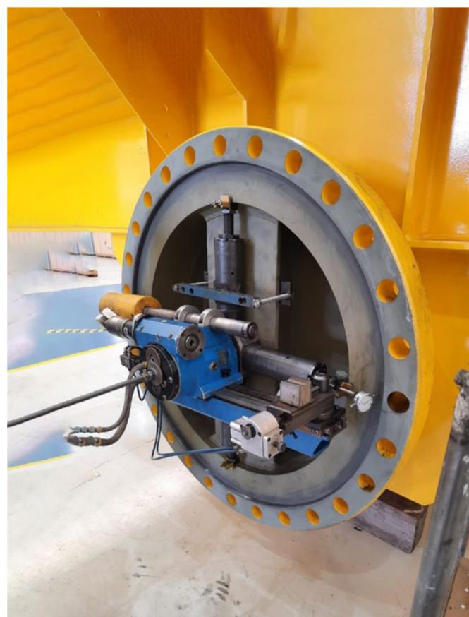
Metalock Brasil foi contratada para realizar reparo em duas flanges de compressor que apresentavam acoplamentos com diâmetro interno e externo incompatíveis, impossibilitando sua montagem.
